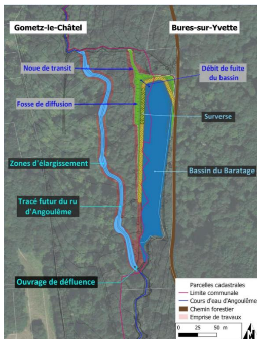
Bassin de Baratage
